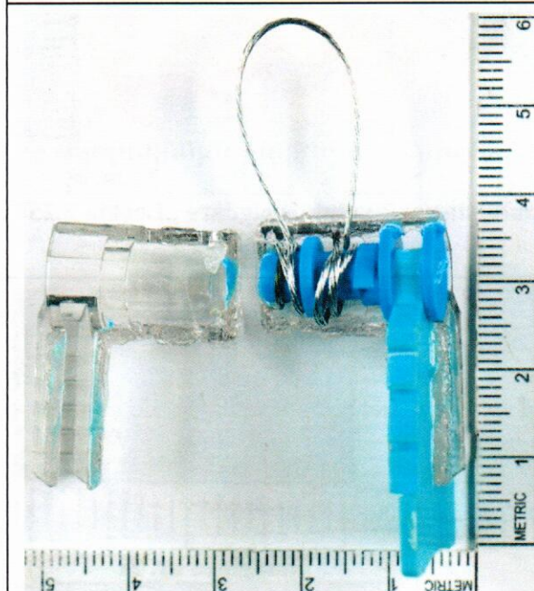
Imaginea nr. 26: Construcția interioară a corpului dispozitivului de sigilare „Meterlock” (1-1149(17)-3/3).
