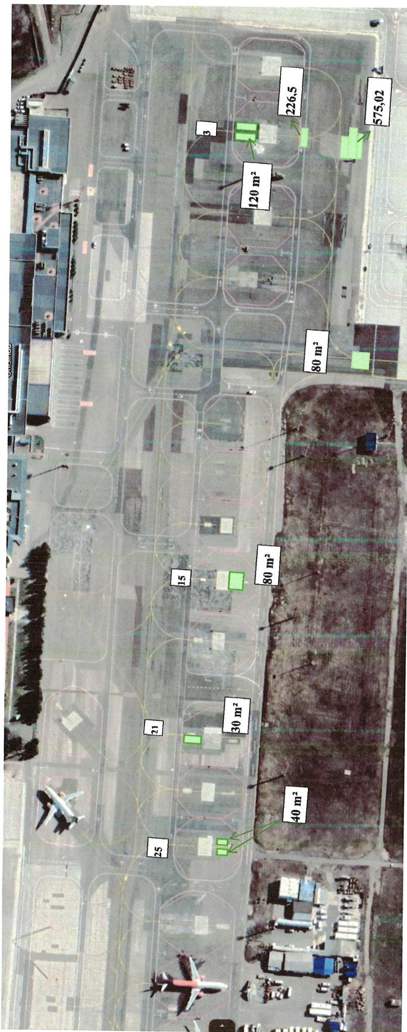
LP nr 25, 21, 15, 3 - Strat de uzură din asfalt. Suprafață –  $1151,52 \text{ m}^2$
