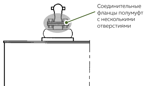
Рис. 55. Муфта с несколькими отверстиями механизма BUL
