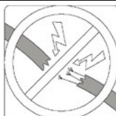
Sprawdzić urządzenie pod względem uszkodzonych przewodów
