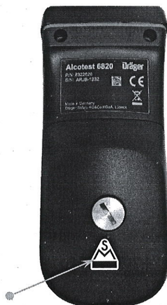
Figura 2. Locul aplicării marcajului aprobării de model.
