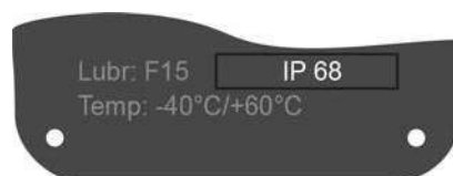
Imagine 34: Plăcuță indicatoare, exemplu cu clasa de protecție IP68
