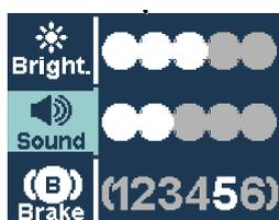
В меню дополнительных настроек регулируются параметры яркости дисплея, громкости звуковой сигнализации и степени торможения.
