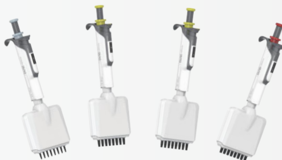
Полностью автоклавируемый механический восьмиканальный дозатор переменного объема с цветными насадками
