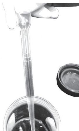
**Рисунок 4. Аспирация до линии отметки на пипетке**
