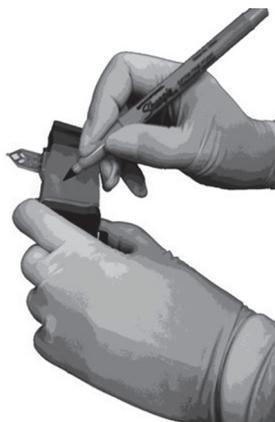
**Рисунок 1. Маркировка картриджа маркером со стойкими чернилами**
