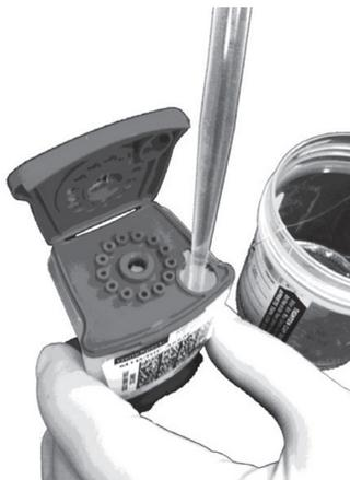
Рисунок 5. Внесение деконтаминированной разжиженного образца в камеру для образца картриджа
