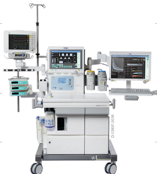
Stație de lucru Atlan® A350 XL incl. monitor pentru pacient Infinity® Delta, C700 pentru SmartPilot® View
