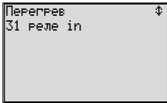
Дискретный вход для сигнала «Перегрев».
