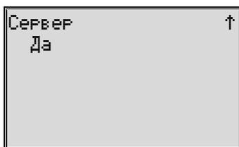
Данная уставка определяет, выполняет ли терминал функции сервера при объединении нескольких терминалов в локальную сеть.
