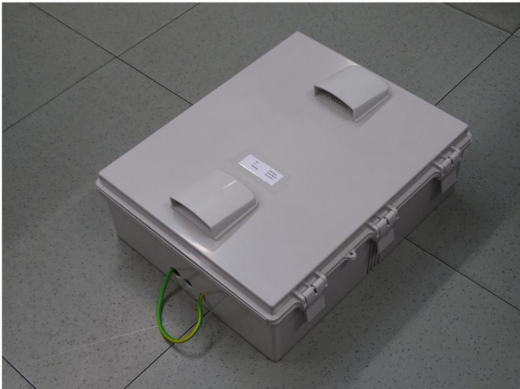
Bild 2-1: Sensorempfänger im Gehäuse
