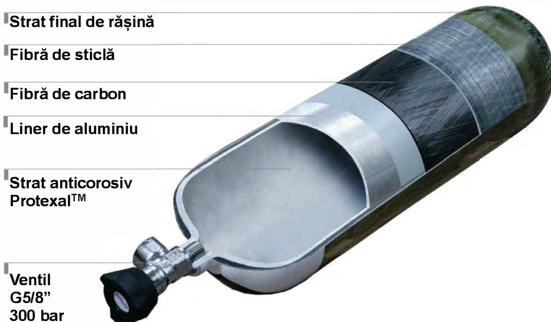
Fig. 7. Butelia de aur din material compozit: a) aspect general al buteliei cu ventilul în prim plan, b) șcema construcției buteliei cu indicarea materialelor folosite..
