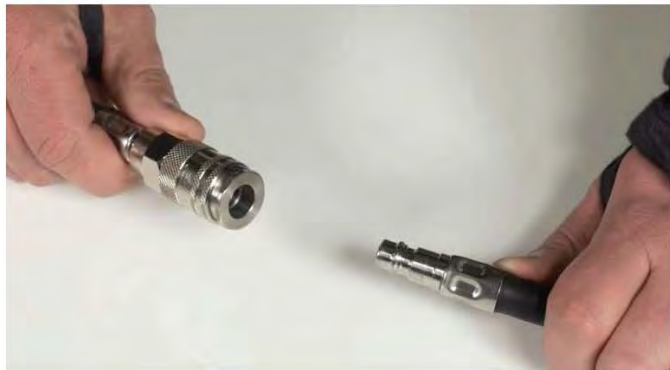
Fig. 9. Conexiunea de tip rapidă, cu autoîmchidere, între conducta de presiune medie și aparatul pulmonar (cuplă mamă la conducta de presiune medie și cuplă tată la conducta de la aparatul pulmonar).
