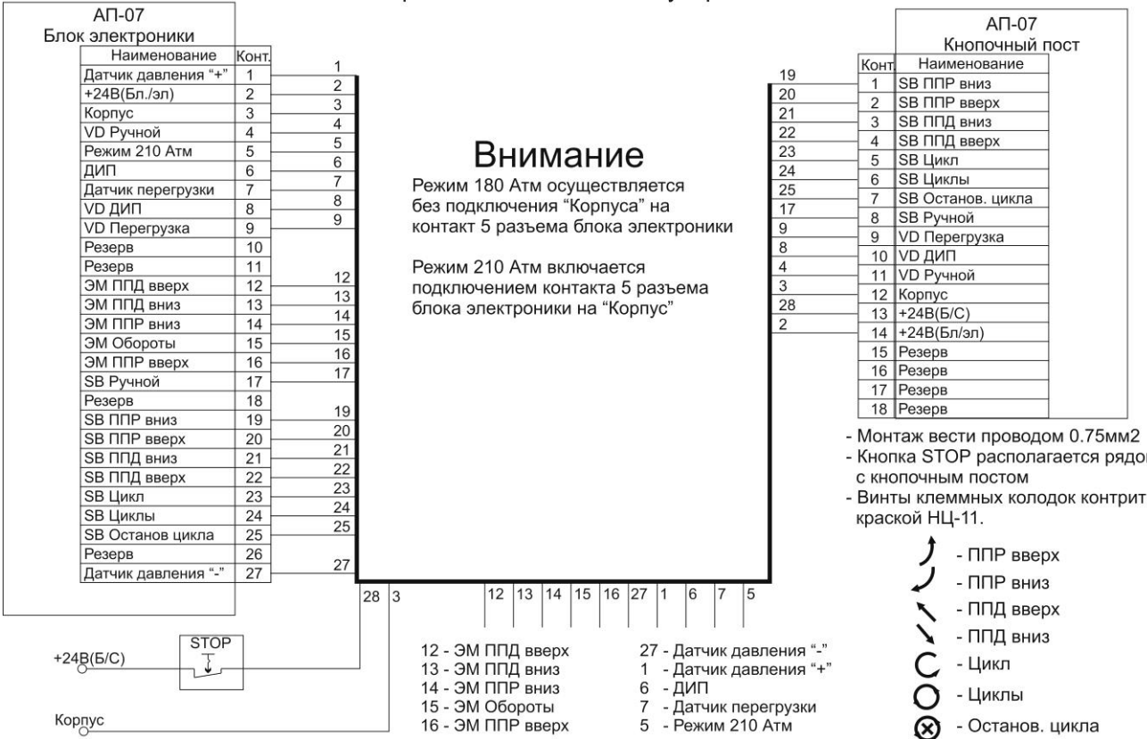
Схема подключения Автомата прессования АП-07 на мусоровоз КО-427
