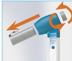
3. Agiteu el transductor per eliminar restes d'aigua, deixeu assecar a temperatura ambient i munteu el conjunt de nou.
