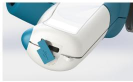
Luego, conecte el cable USB en el conector marcado con
