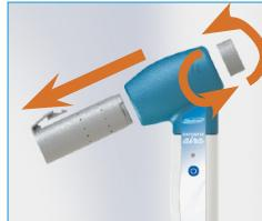
3. Agite o transdutor para eliminar restos de água, deixe secar à temperatura ambiente e monte novamente o conjunto.
