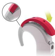
Fig. 36: Atașarea capacului pentru microfon
