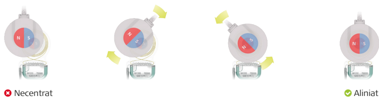
Fig. 9: Alinierea antenei cu magneții implantului
