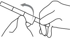
Rupeți porțiunea cu clapetă de pe etichetă și ataşați-o la placa cu mediu de cultură primară sau înregistrarea pentru control calității. Nudezamblați dispozitivul în timpul hidratării.
