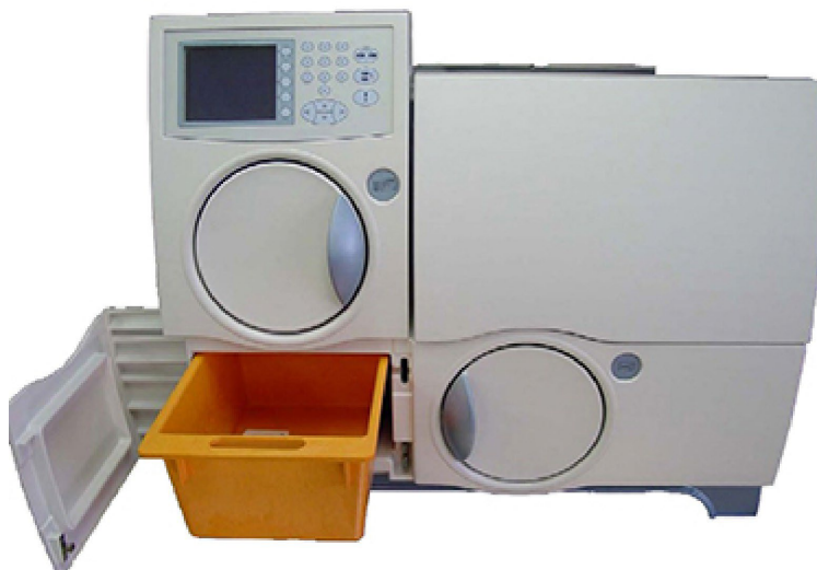
Fig. 52. Stația de colectare a materialelor uzate (deschisă)
