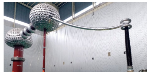
±500kV GLS 出线套管出厂试验 Routine test of 500KV GIS bushing
