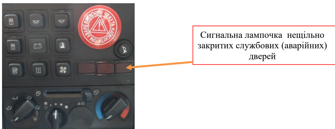
Рис. 15.7 Розміщення сигнальної лампочки нещільно закритих запасних (аварійних) дверей
