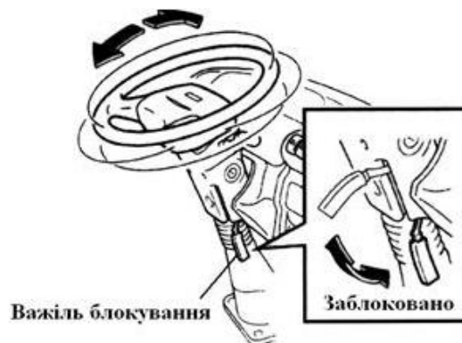
Рисунок 4.7.1 – Регулювання положення кермового колеса
