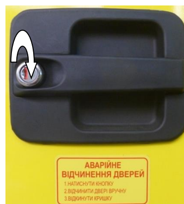
Рис. 15.2 Ручка для відчинення запасних (аварійних) дверей
