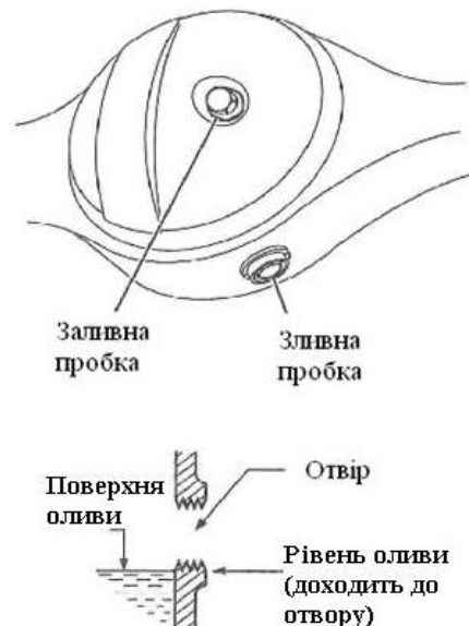
Рисунок 12.7.5.2 – Олива редуктора заднього мосту
