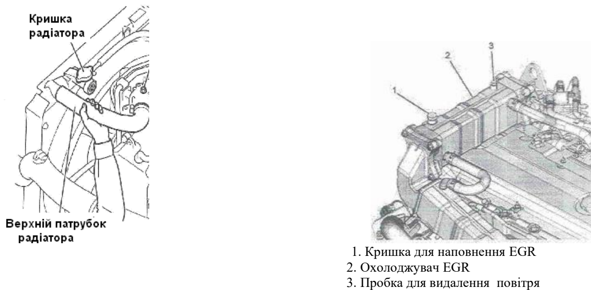
Рисунок 12.4.3.1 – Заміна охолоджуючої рідини
