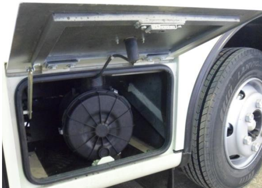
Рисунок 12.5.1 – Розміщення повітряного фільтра
