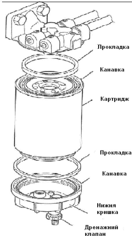
Рисунок 12.6.1.3 – Паливний фільтр грубого очищення в відсіку кузова
