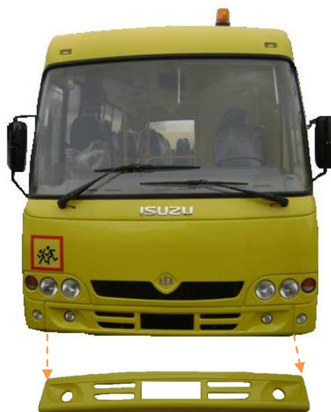
Рис. 16.2 Демонтаж середньої частини бампера
