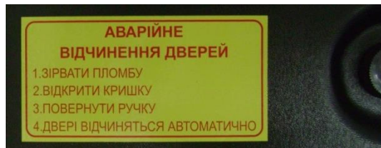
Рисунок 4.3.2 – Інструкція до крана аварійного відчинення службових дверей
