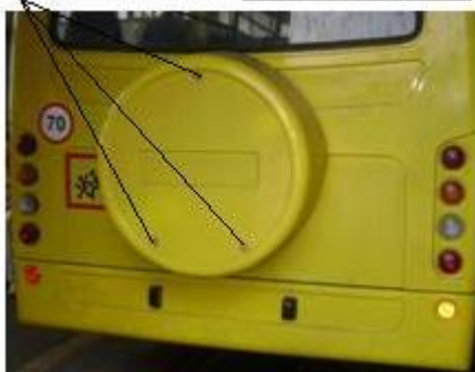
Гайки кріплення захисного кожуха
