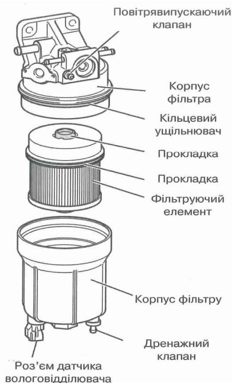
Рисунок 12.6.1.2 – Будова паливного фільтра на двигуні
