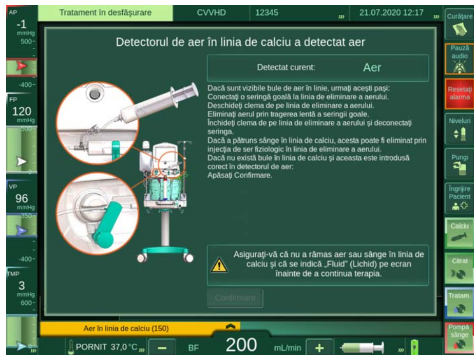
Imaginea 8-26 Detectorul de aer în linia de calciu a detectat aer
