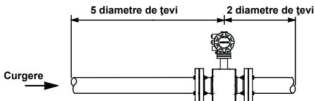
Figura 4. Diametre de țevi drepte în amonte și în aval
