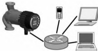
Figura 6: Collegamento alla rete via router
