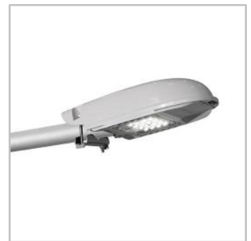
Reglare precisă la fața locului. Unghiul de înclinare poate fi setat de la -15° la +5° pentru montaj lateral și de la -10° la +10° cu ajutorul piesei de fixare pentru montaj în vârf de stâlp.
