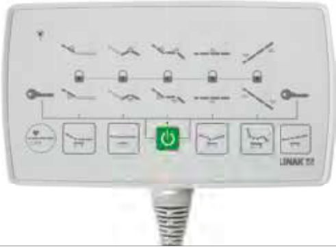
HEMŞİRE KONTROL ÜNİTESİ / NURSE CONTROL UNIT
