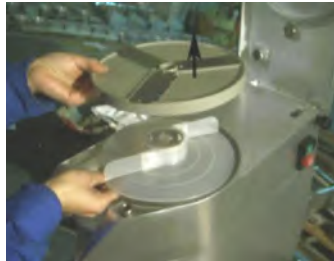
Installation der Schneidescheibe (4)
