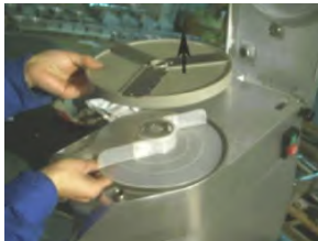
Instalación de lámina para cortar (4)
