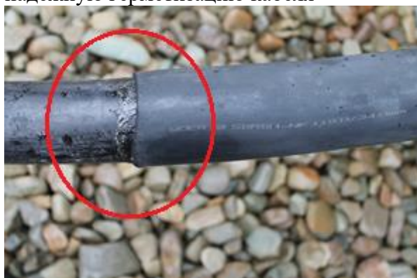
Рис.22 Выделение клея в процессе нагрева термоусадочной трубки
