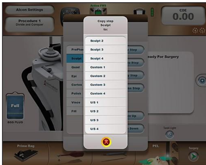
Figura 2-66 Etapa Copy (Copiere) (sau Rename (Redenumire)) în caseta de dialog Procedure Builder (Configurare intervenție chirurgicală) În acest caz, utilizatorul a selectat etapa Copy (Copiere) din caseta de dialog Procedure Builder (Configurare intervenție chirurgicală), chiar dacă etapa Rename (Redenumire) afișează aceleași selecții pentru tipul de etapă selectat. Copierea unei etape creează copii ale tuturor setărilor unui medic salvate sub un nou nume de etapă, în timp ce redenumirea unei etape doar schimbă denumirea acesteia.
