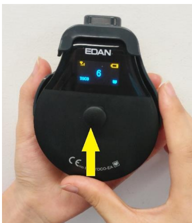
Рис. 8-7. Установка муфты электрода
