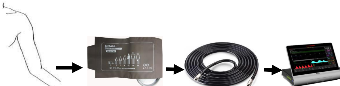
Рис. 8-10. Соединение для измерения нАД
