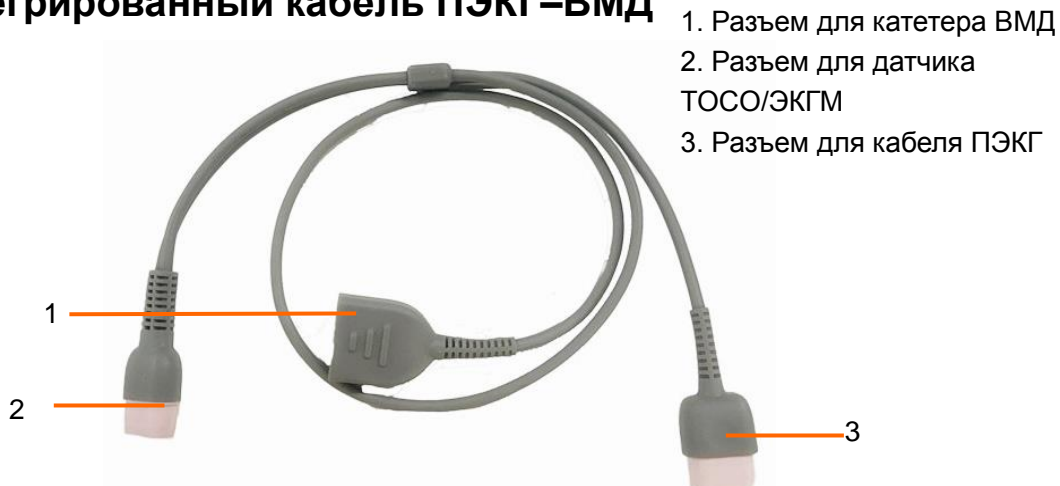
Рис. 3-16. Интегрированный кабель ПЭКГ-ВМД
