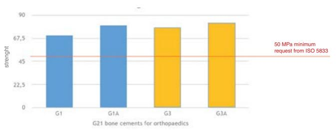
**DETERMINATION OF BENDING STRENGTH OF POLYMERIZED CEMENT [10]:**
