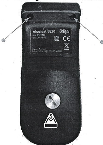
Figura 3. Locurile de aplicare a marcajului metrologic de verificare.
