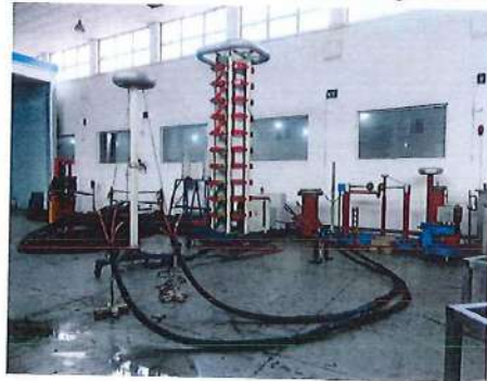
E3: 冲击电压试验 Impulse voltage test
