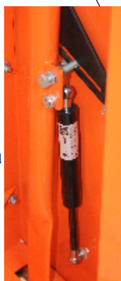
Cilindru cu gaz pentru o coborare / ridicare mai usoara a discului
