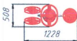
Componente: pilon de sprijin, bază inferioară și sistem de pârghii, minere, suporturi pentru picioare, disc retitor. Pilonul de sprijin al echipamentului este confectionat din teava din otel, cu grosimea 3 mm și diametrul de 133 mm, fiind montat pe o platformă cu gauri pentru fixarea cu fundamentalul.
