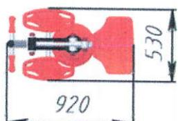
Componente: bază inferioară, sistem de pârghii, mânere, scaun, suport pentru picioare.
