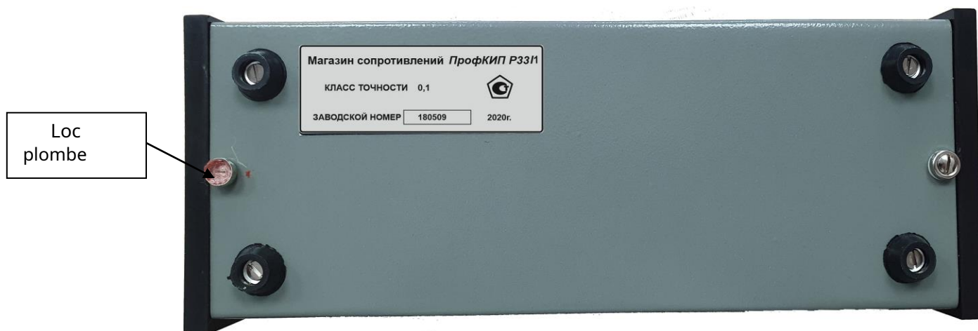
Figura 2 – Diagramă de etanșare pentru a preveni accesul neautorizat.
