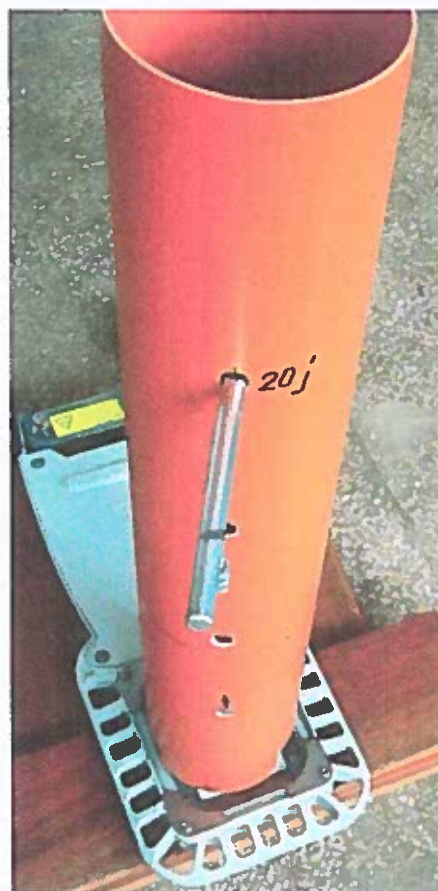
Fig. 2 – Corpul de iluminat VOLTANA 1-8L – Cod VOLTA1-000457 pregătit pentru verificarea impact (IK 10)
