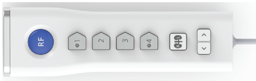
Слика 4. Далечински управувач што се чува во футрола на страничниот панел на радиофреквентен генератор за ренална денервација Symplicity G3
