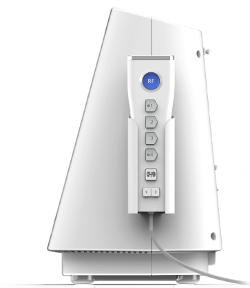
Εικόνα 4. Τηλεχειριστήριο τοποθετημένο σε θήκη στην πλευρική επιφάνεια της γεννήτριας ραδιοσυχνότητας νεφρικής απονεύρωσης Symplicity G3
