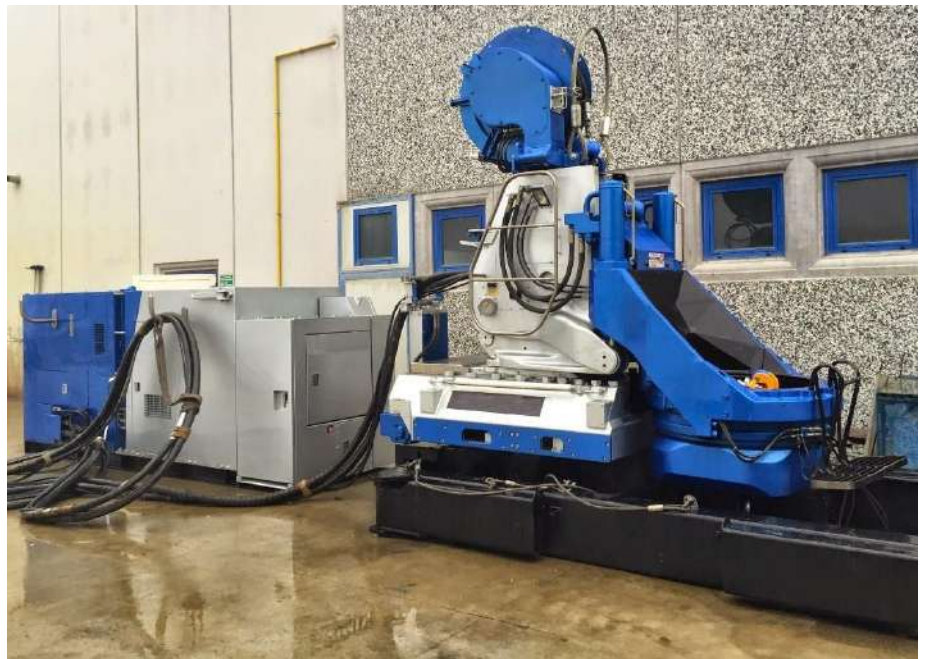
Presă Silent Piler ZU-100 - water jetting mode
