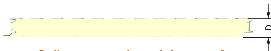
Secțiune panou perete cu prindere ascunsă
