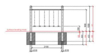
Yapı dört dikey sütundan oluşmaktadır. Yapı uzunluğu 2100mm. Paralel çubuklar 15 mm kalınlığında HDPE polietilenden imal edilmiştir. Sütunlar arasındaki mesafe 900 mm'dir. İnşaat metal kelepçelerle birbirine sabitlenir.
