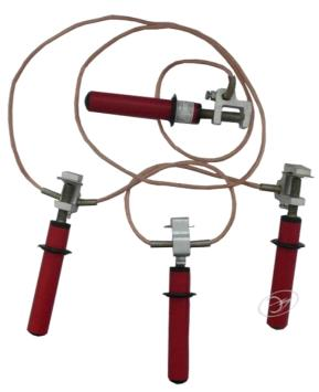
Предназначено для защиты работающих на отключенных участках оборудования распределительных устройств от порожении электрическим током в случае ошибочной подачи напряжения на этот участок или появления на нем наведенного напряжения. Допусимый диапазон рабочих температур от -45°C до +45°C. Относительная влажность воздуха до 80% при 20°C.
