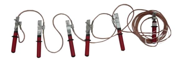
Предназначено для защиты работающих на отключенных участках воздушных линий от поражения электрическим током в случае ошибочной подачи напряжения на этот участок или появления на нем наведенного напряжения. Допустимый диапазон рабочих температур от -45°C до +45°C. Относительная влажность воздуха до 80% при 20°C.
