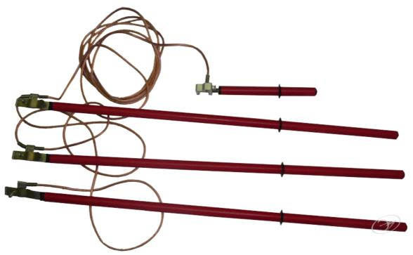
Предназначено для защиты работающих на отключенных участках оборудования ВЛ на случай ошибочной подачи напряжения на этот участок или появления на нем наведенного напряжения, и обеспечивает возможность наложения и снятия заземления на провода сечением от 6 до 600 мм². Допустимый диапазон рабочих температур от -45 °C до +45°C. Относительная влажность воздуха до 80% при 20°C.
