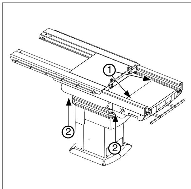
Fig. 76: Table, lubrication
