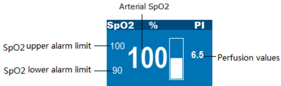
Figure 10-1: SpO<sub>2</sub> parameter display
