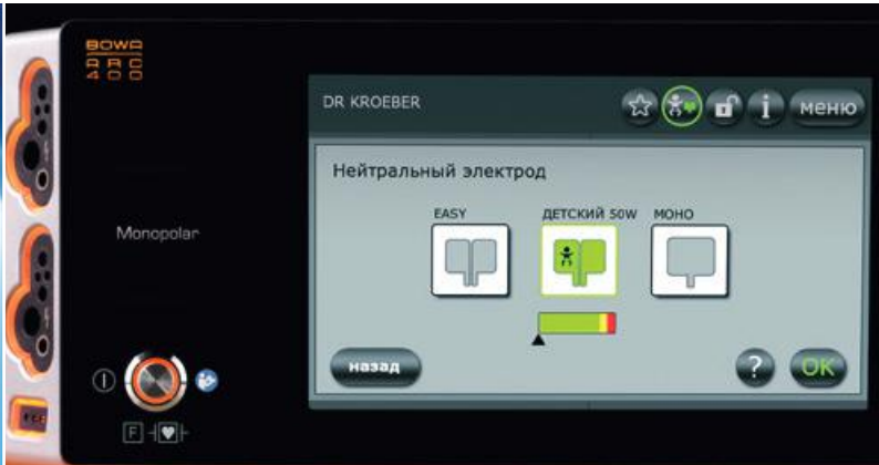
Контроль нейтрального электрода непрерывно информирует пользователя о статусе. Например, настройки детского электрода с ограничением мощности (макс. 50 Вт)
