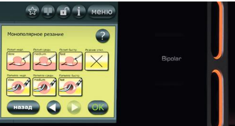
Высокая гибкость настроек: GastroCut позволяет выполнить 6 типов разреза и достигать до 9-ти уровней эффектов
