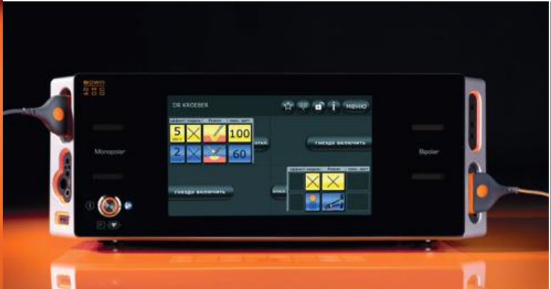
Наглядность: каждый подключенный разъем, на изображении это верхний левый и нижний правый разъемы, соотносен с определенным квадрантом экрана
