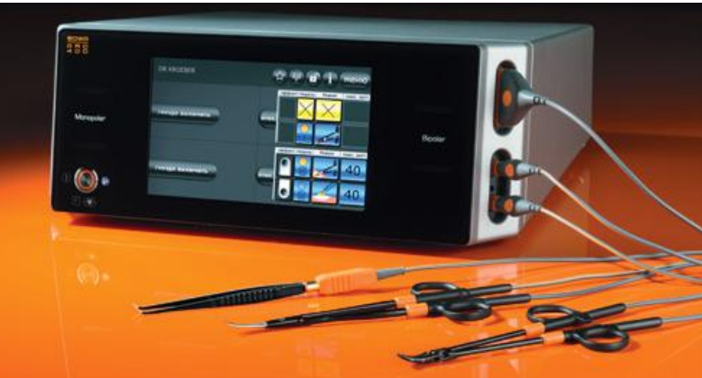
Эффективность: при монополярной коагуляции можно активировать два инструмента одновременно
