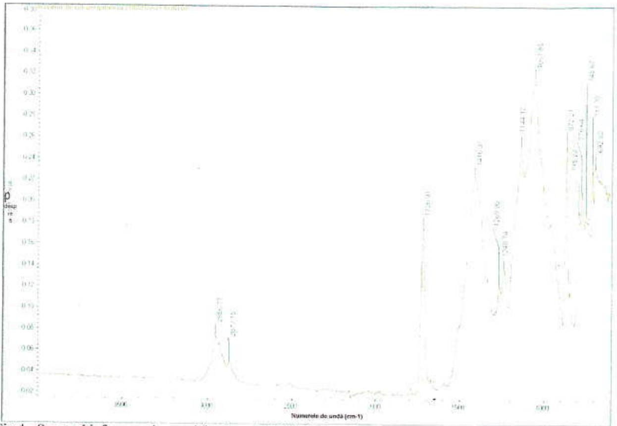
Fig.4 - Spectrul infraroșu al vopselei solvent KONTUR de culoare de culoare galbenă - acoperire
