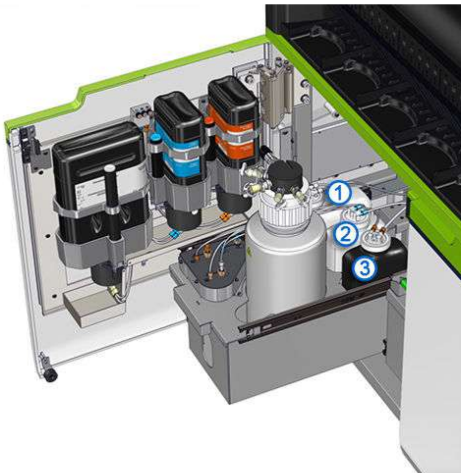
Figură 172: Componentele rezervorului de soluție vrac (i-series)
