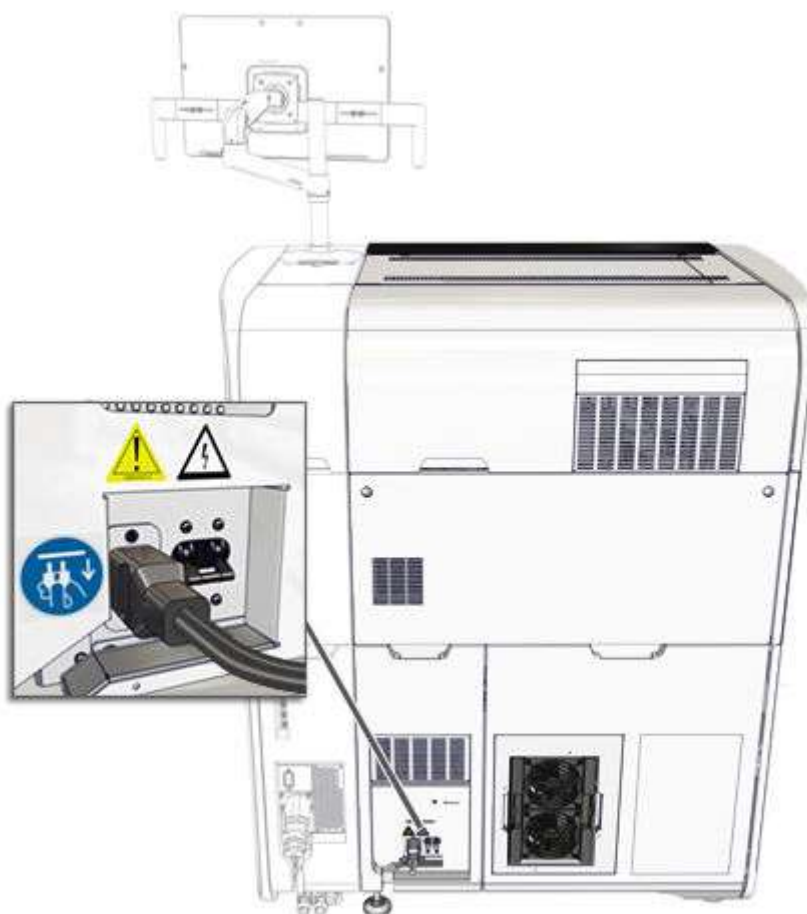
Figură 135: Întrerupător de alimentare pentru modulul de procesare Alinity c
