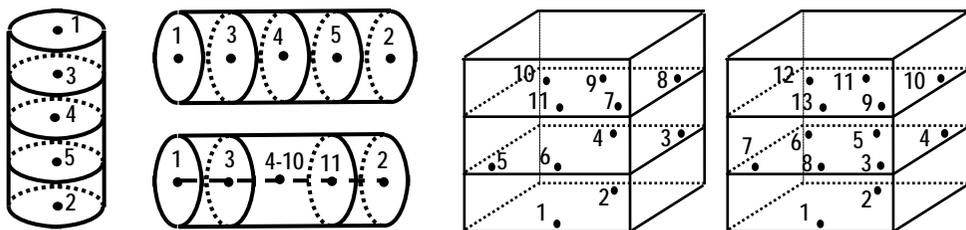
Рис. 1 - Расположение контрольных точек в камере паровых стерилизаторов.
