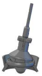
Figura 15a: Suport de susținere/rotație a valvei fixat impropriu.
