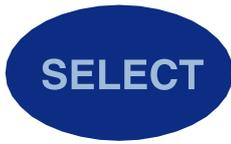
Нажмите и **удерживайте** кнопку SELECT (ВЫБОР) в нажатом состоянии (около 4 секунд) до тех пор, пока не услышите звуковой сигнал входа в режим программирования.
