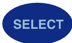
Для выбора параметра экспозиции, требующего изменения (напряжения в кВ, тока в мА или времени экспозиции) необходимо нажать на короткое время кнопку SELECT (ВЫБОР). Когда значение параметра на дисплее мигает, его можно изменить. Через 5 секунд после завершения регулировки напряжения (кВ), тока (мА) или времени установка автоматически вернется в режим настройки времени экспозиции.
